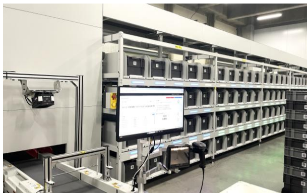
商品自動で高速に仕分けする「立体型自動仕分けシステム」
